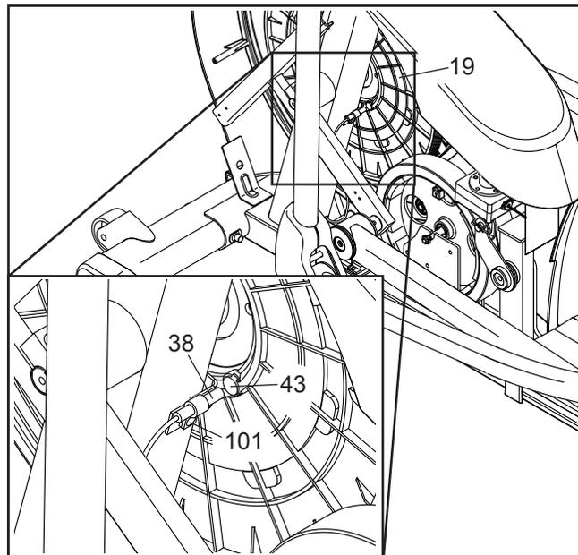
Затем ослабьте указанный винт М4 х 16 мм (101). Немного переместите геркон (38) от или к магниту (43), а затем затяните винт.
